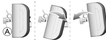
Desaperte os parafusos de orelhas **A** e rode a almofada do joelho à volta da barra transversal até a posição pretendida.
