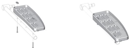
1. Com as ferragens de fixação fornecidas, instale o corpo moldado da almofada do braço na barra do apoio de braço na orientação de montagem pré-determinada (veja acima) e na posição da almofada do braço (veja os ajustes de largura e profundidade abaixo).
