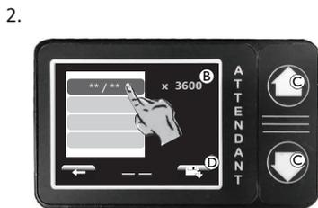
Toque na função de programação desejada para alterar o valor **B** premindo as setas para cima ou para baixo **C**. Toque no botão **D** para guardar o ajuste.
