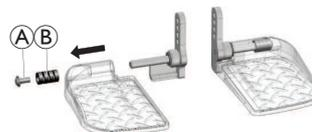
Remova o parafuso de montagem do apoio para os pés **A** e os espaçadores **B**.
