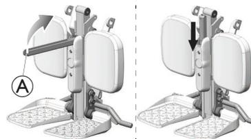
1. Dobre a barra de montagem (A) e guarde-a atrás da cobertura do apoio de pernas.
