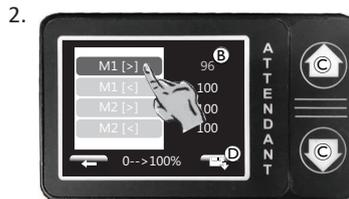
Toque no atuador desejado (> = estender < = retrain) para alterar o valor (B), premindo as setas para cima ou para baixo (C). Toque no botão (D) para guardar após cada ajuste.
