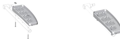
1. Utilizando as ferragens fornecidas, instale o corpo moldado da almofada de braço no tubo do apoio de braço na orientação de montagem predeterminada (veja acima) e na posição da almofada de braço (veja os ajustes de largura e profundidade abaixo).
