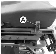
A posição do suporte de montagem (A) está na calha esquerda ou direita do assento.
