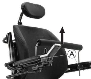
1. Levante a barra torácica para desengatar ambas as colunas dos suportes de montagem esquerdo e direito **A**.
