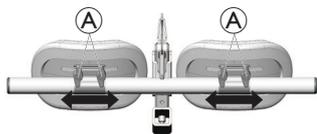
1. Desaperte os parafusos de orelhas **A** e deslize as joelheiras para dentro ou para fora até à posição desejada na barra transversal.
