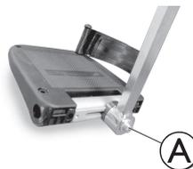
1. Desaperte o parafuso de fixação do apoio para os pés **A**.
