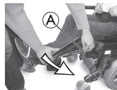
1. Mantenha o apoio de pernas na área da placa de pés, puxe a alavanca de ajuste lateral **A** e baixe lentamente o apoio de pernas.
