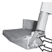
1. Desaperte os dois parafusos de fixação do apoio para os pés.
