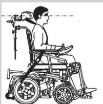
O “modelo do teste de colisão” foi preso utilizando cintos de segurança pélvicos e na parte superior do corpo. Devem ser utilizados ambos os tipos de cinto de segurança de modo a minimizar o risco de lesões para a cabeça ou parte superior do corpo.
