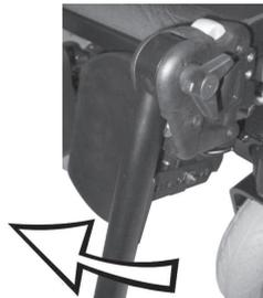
Rodar o apoio de pernas para cima para chegar ao amortecedor de borracha.
