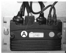
Retire o cabo de bateria **A** do módulo de alimentação.
