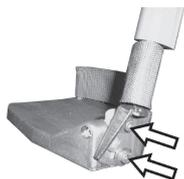
1. Desaperte os dois parafusos de fixação do apoio para os pés.
