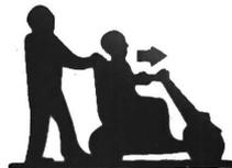
Este símbolo indica a posição de "Empurrar" da alavanca de embraiagem. Nesta posição, o motor está desengatado e os travões do motor não estão operacionais. O veículo elétrico pode ser empurrado por um assistente e as rodas funcionam sem restrições.
