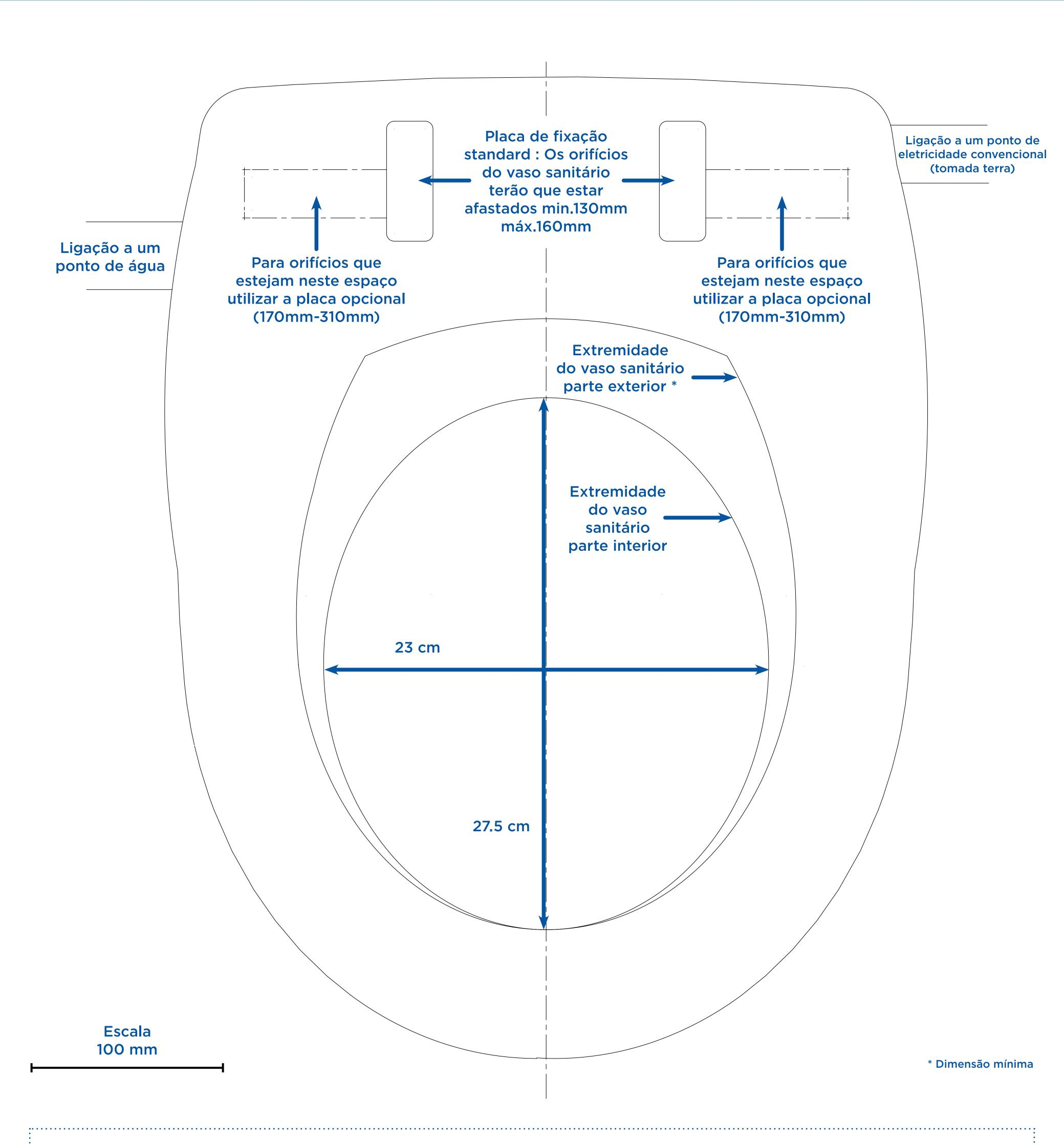
Verifique se o Pure Bidet é compatível com o vaso sanitário onde é pretendido ser montado.
