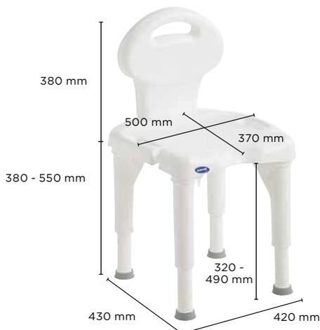
Ergonómica e prática, esta cadeira de duche proporciona grandes possibilidades de regulação, graças ao seu sistema de ajuste através de parafusos, o que permite ao assento atingir uma altura de 380 mm a 550 mm.
